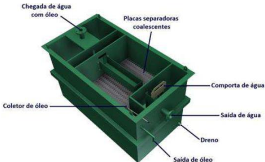
Foto 3-2. Tipo de SSAO instalada no Poço de Drenagem da Casa de Força da PCH Foz do Estrela.
